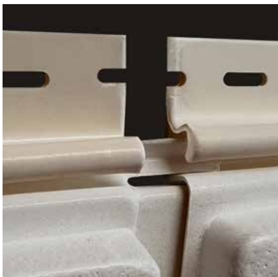
Рис. 17 Усиление жёсткости вертикального соединения панелей (необходимо выполнять при отделении стойки обрешётки на расстоянии более 100 мм)
