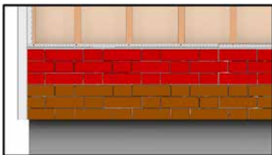
Рис. 18 Монтаж последующих рядов сайдинга Döcke LUX BERGART
